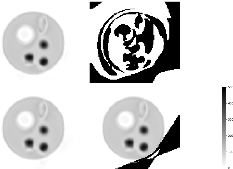
FIGURE 3.14 – Images obtenues pendant la reconstruction du fantôme cylindrique 3 avec l’algorithme DNA-APPGML et une borne A = -10 . La première ligne montre les images au bout de 2 et 3 itérations externes du DNA-APPGML. La deuxième ligne montre les images obtenues pendant la troisième itération externe lors de la reconstruction par APPGML au sein du DNA-APPGML (à 5 et 6 itérations internes).
